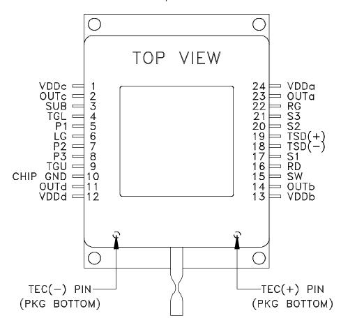
FIGURE 5 SIA003A pin labels
